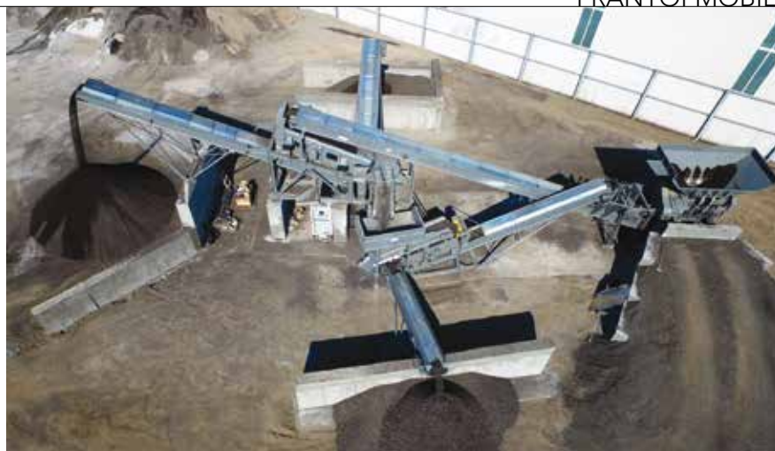
2. L'impianto Cams per il recupero dell'asfalto
